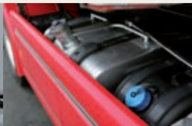
Sans pour autant pouvoir se tromper, AdBlue et carburant sont positionnés côte à côte.
