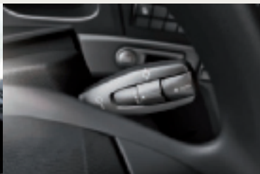
La nouvelle commande de la boîte de vitesses est à présent au volant.
