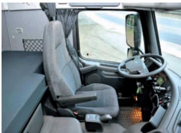
Le tunnel moteur, bien présent, autorise malgré tout une hauteur intérieure de 1670 mm.
