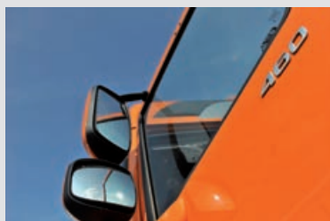
Le vitrage latéral d'un seul tenant apporte de la sécurité en plus.
